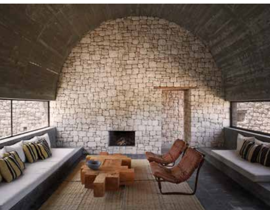
Cœur de pierres. Le clou du spectacle dans le salon de la Villa DL, à Essaouira ? Le mur en pierres – ramassées dans le maquis alentour –, coiffé d'une voûte en béton brut de décoffrage. Banquettes en ciment lissé réalisées sur mesure et table basse taillée dans un bloc de bois local.
